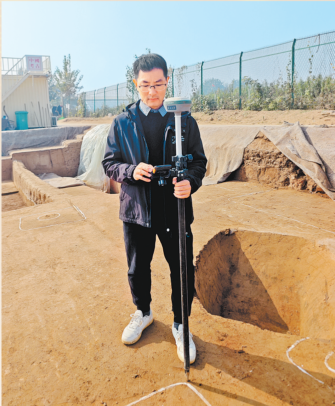
何凯使用RTK进行遗迹测绘。 受访者供图
