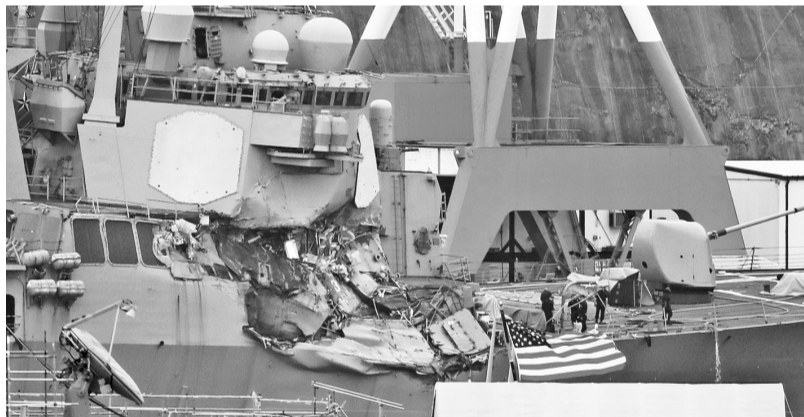
美军“菲茨杰拉德”号驱逐舰被撞的部位是右舷的舷侧,恰是军舰脆弱的部位。东方IC供图
